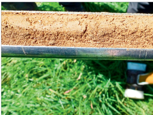
Begutachten des Bohrkerns
